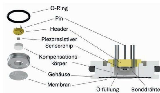
Abbildung 2: Aufbau eines isolierten, ölgefüllten piezoresistiven Drucksensors.
