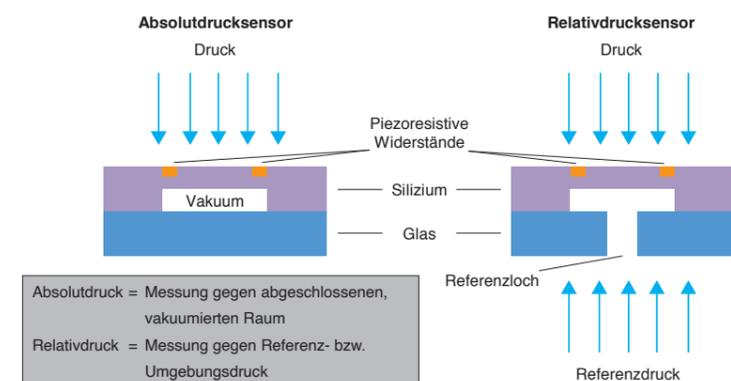
Abbildung 1: Aufbau des piezoresistiven Sensorchips.
